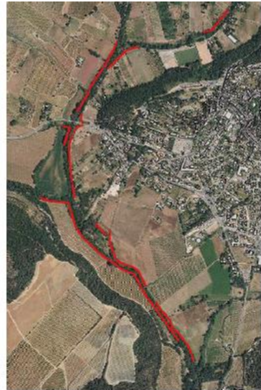
Figure 17 : Localisation des remblais en lit majeur
